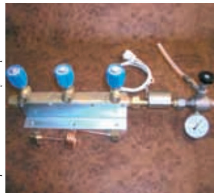
Станция подачи закиси азота (рис. 7)
